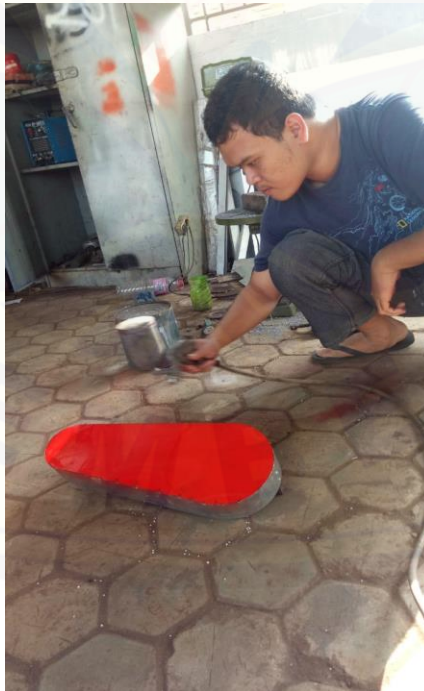
Gambar C.13 Pengecatan pada Penutup Pulley
