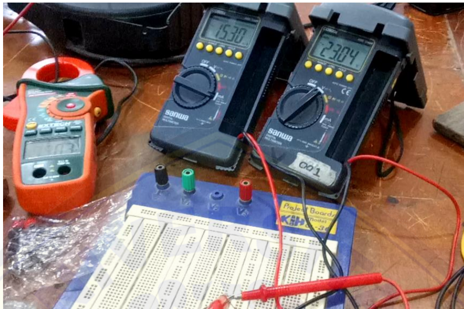
Gambar 5. Pengujian Generator Pada Output Tegangan 23 V Menggunakan Multimeter
