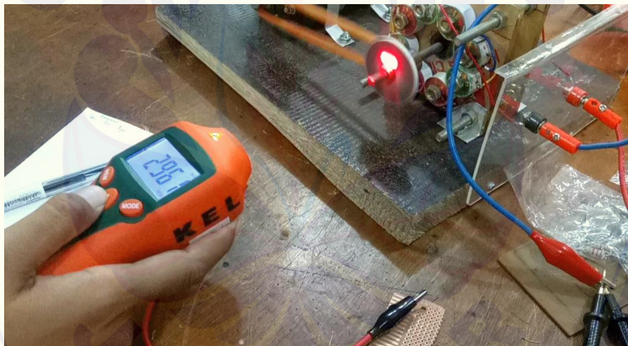
Gambar 4. Pengujian Generator Pada Output Tegangan 20 V Menggunakan Tachometer
