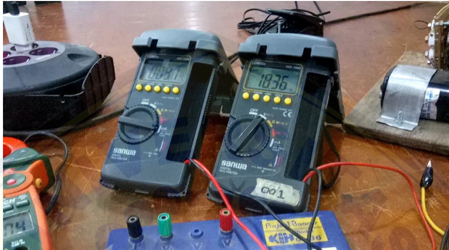
Gambar 1. Pengujian Generator Pada Output Tegangan 18 V Menggunakan Multimeter
