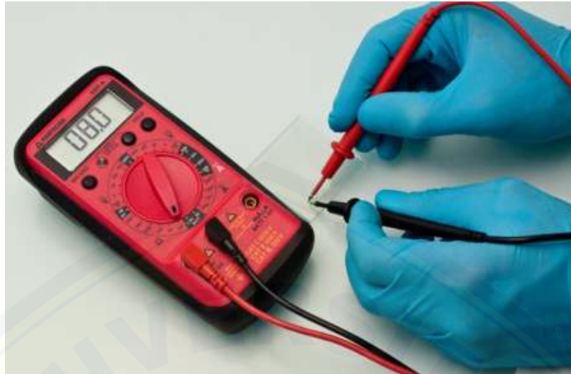
Gambar 2.12 Pengujian Resistansi ( Martineau, 2012)
