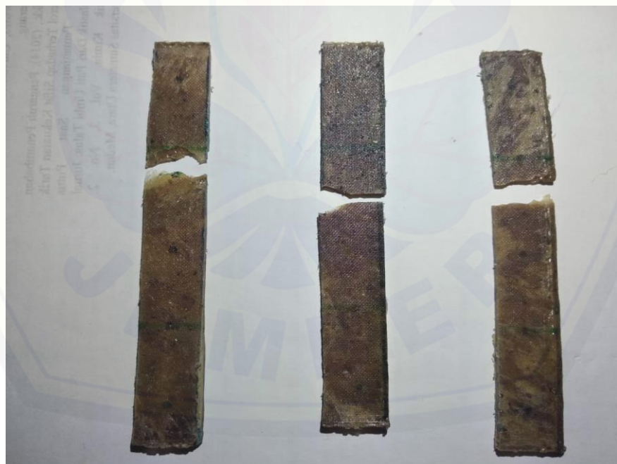
Gambar 24. Perbandingan PET 75%; Sorbitol 20%; Pati 5% (pb4)
