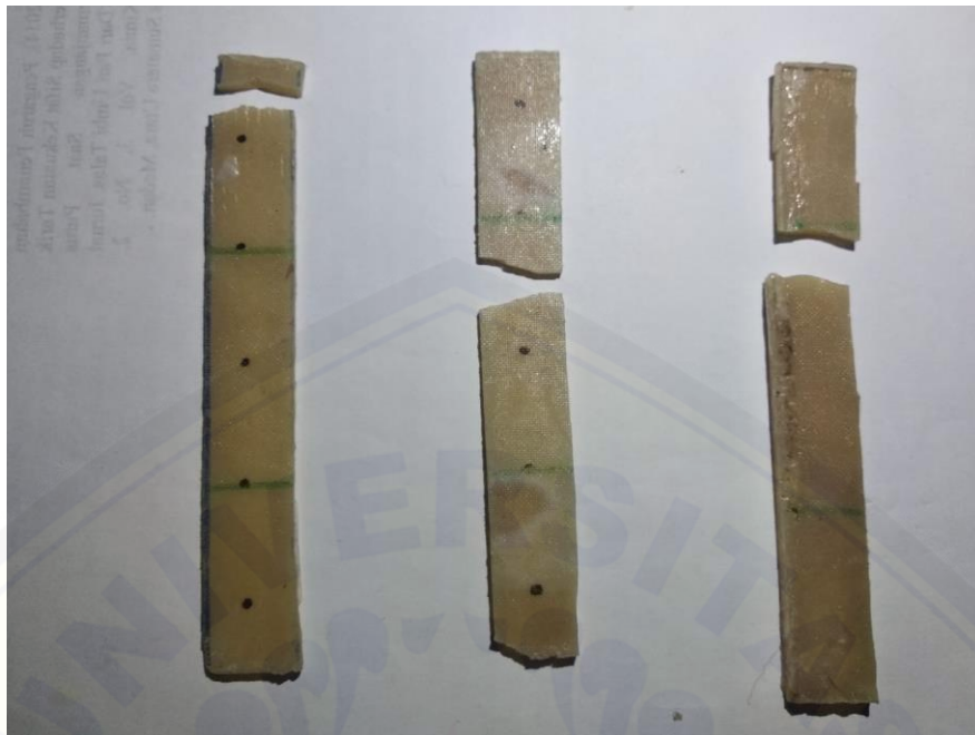
Gambar 25. Perbandingan PET 80%; Sorbitol 20%; Pati 0% (pb5)
