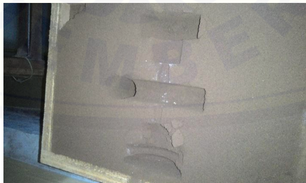
e. Pembuatan bentuk pola pada cetakan pasir
