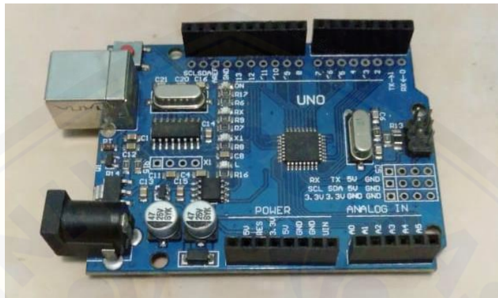
Gambar 3. 7 Arduino Uno (Laboratorium Konversi Energi, UNEJ)
