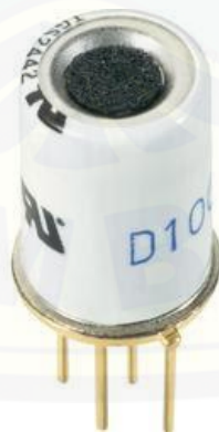
Gambar 3. 6 Sensor TGS2442 (Laboratorium Konversi Energi, UNEJ)
