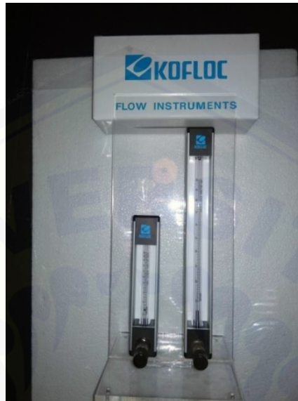
Gambar 3. 4 Flowmeter bahan bakar ( kiri ) dan Flowmeter udara ( kanan ) (Laboratorium Konversi Energi, UNEJ)
