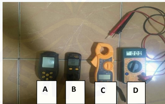
(A) Tachometer; (B) Anemometer; (C) Tang ampere; (D) Avo meter
