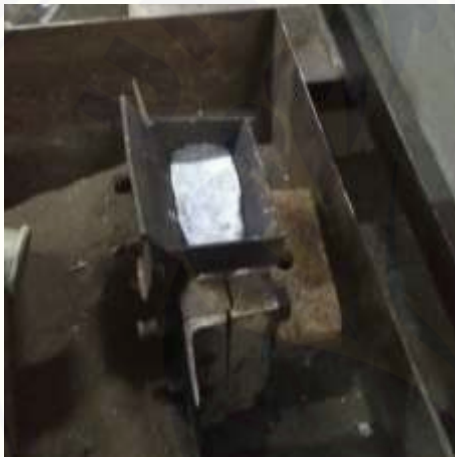
Penuangan dalam cetakan
