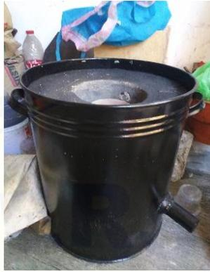
**Lampiran 5 Proses fabrikasi cetakan pasir pengecoran logam**
