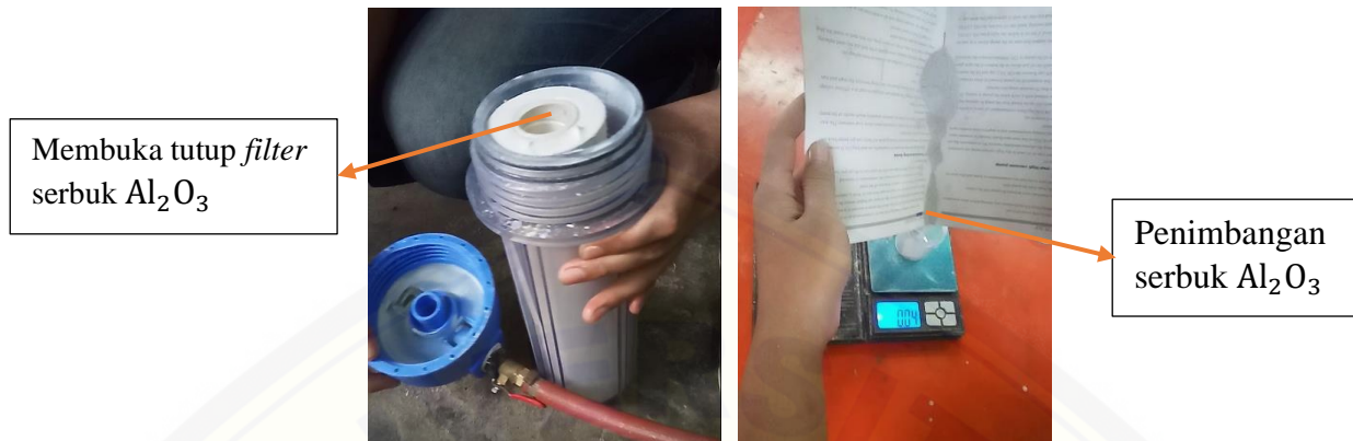
Gambar 3.8 Proses pembukaan saringan nano dan kolektif serbuk Al 2 O 3
