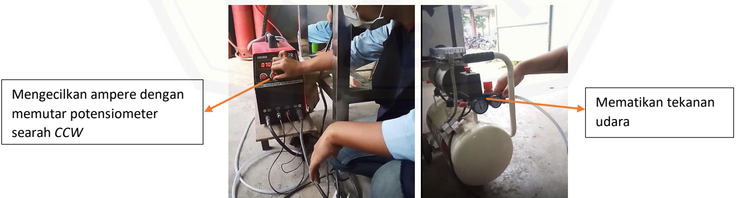
Gambar 3.7 Proses mematikan mesin DC dan menutup kran kompresor
