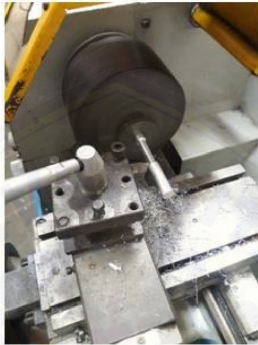
Proses pembubutan spesimen
