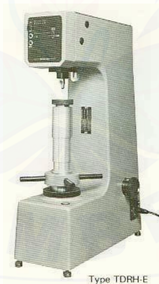
Gambar 2.11 Konstruksi alat uji kekerasan Rockwell (Sudjana, 2008)
