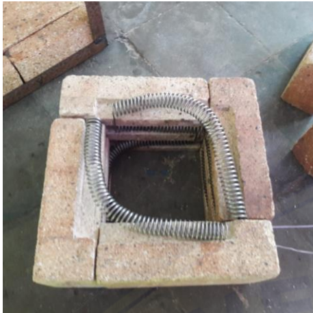
Pembuatan dapur pengecoran
