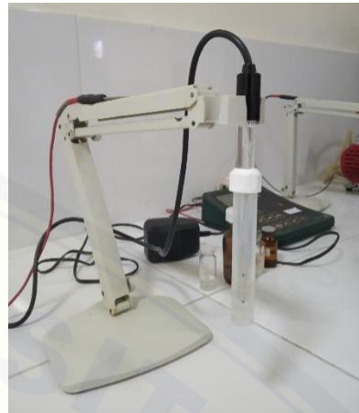
Pengujian pH dengan pH meter
