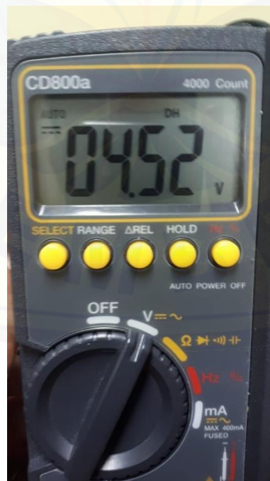
Pengujian Tegangan Catu Daya Pemantau infus (R.Pasien) Tanpa Beban
