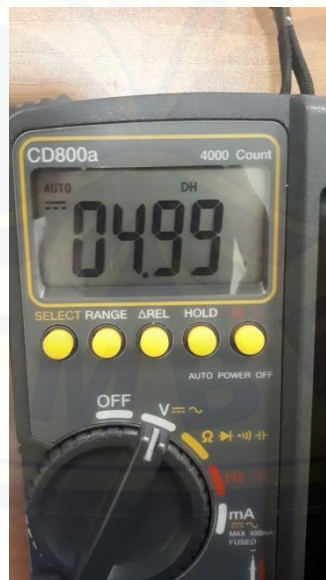
Hasil Pengujian Tegangan Catu Daya tetes Infus Otomatis Tanpa Beban
