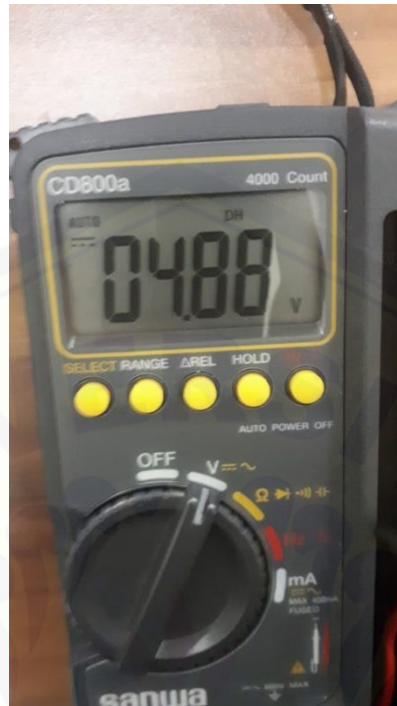
Hasil Pengujian Tegangan Catu Daya tetes Infus Otomatis Dengan Beban
