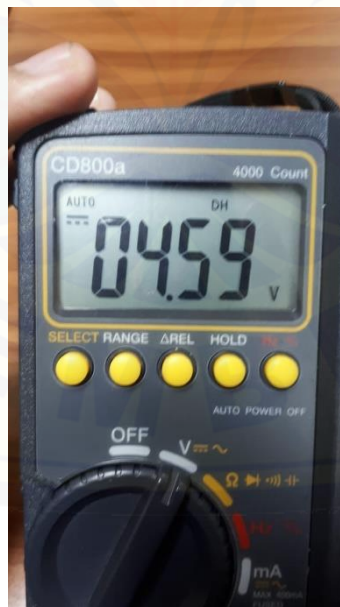
Pengujian Tegangan Catu Daya Pemantau infus (R.Pasien) Dengan Beban
