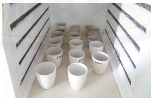
Pengujian Kadar Abu
