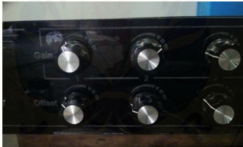
Potensio pengatur offset dan gain untuk strain gauge
