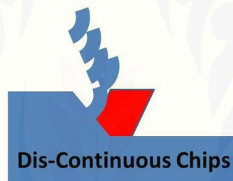
Gambar 2.12 Tatal tidak kontinu ( discontinuous chips ) (Sumber: https://2.bp.blogspot.com , diakses pada 25 Februari 2019)
