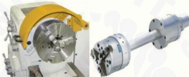
Gambar 2.3 Kepala tetap terpasang cekam pada spindle utama mesin bubut (Sumber: Universitas Islam Indonesia 2016)
