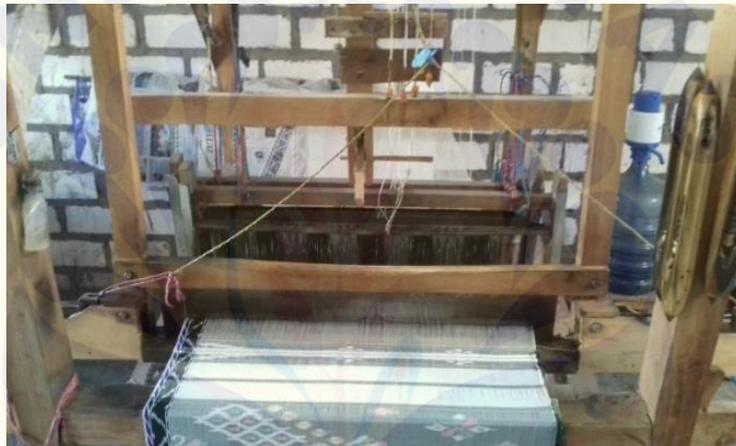
Gambar 2. 3 Alat Tenun Bukan Mesin (ATBM)
