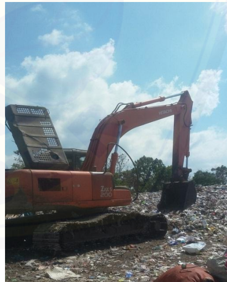
Gambar 4. Kegiatan memindahkan, meratakan dan memadatkan sampah dengan excavator
