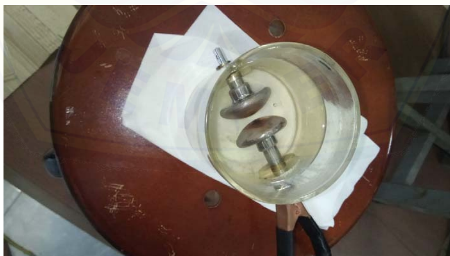
Gambar 2. Pengujian Breakdown Voltage sebelum ditembuskan
