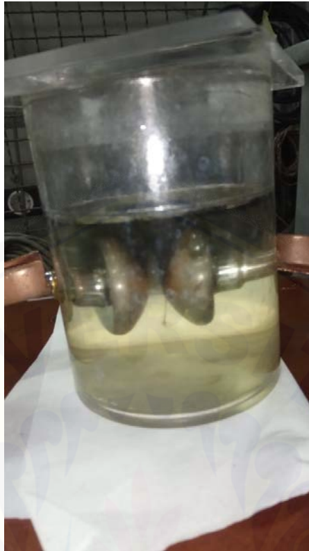
Gambar 3. Pengujian Breakdown Voltage Setelah Ditembuskan
