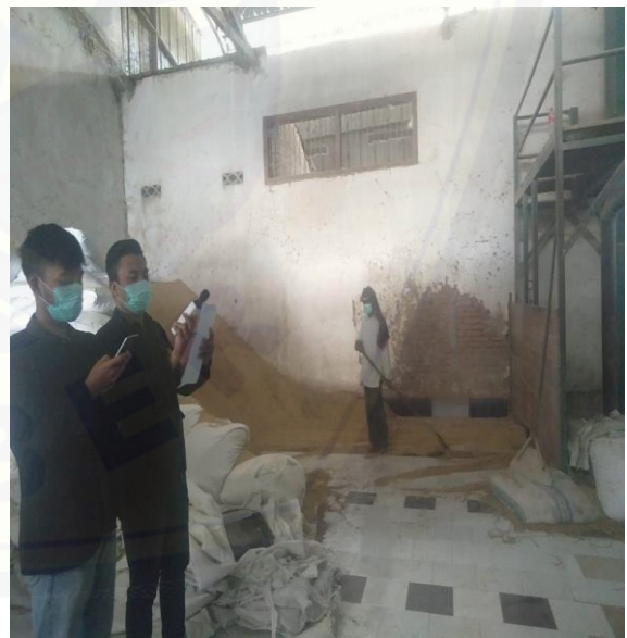
Gambar 4. Pengukuran Intensitas Kebisingan di Titik X4
