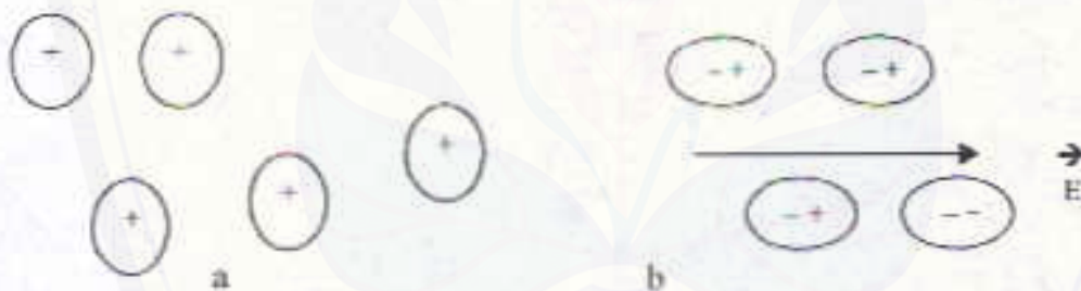
Gambar. 2.6 (a) Molekul tak polar, pusat muatan positif dan negatif ada ditempat yang sama. (b) Dalam medan listrik, molekul mendapat momen dipol listrik.
