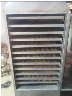
Proses Pengeringan menggunakan mesin pengering kabinet
