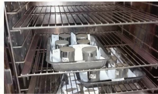
Proses pengovenan ring sampel selama 12 jam
