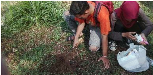
Pengambilan sampel tanah tak terusik pada Sub DAS Bintoro
