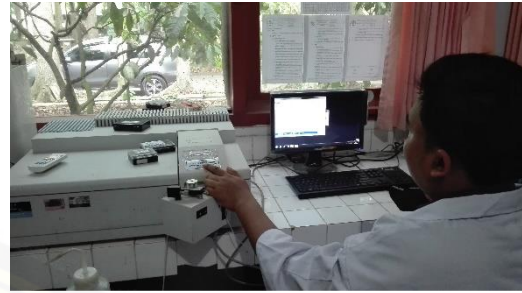
Mengukur absorpsi larutan jernih dengan spektrofometer
