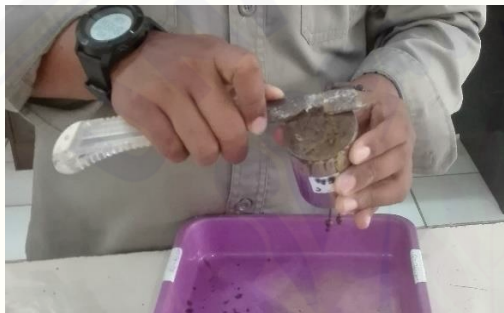
Meratakan permukaan tanah di ring
