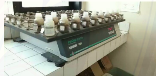
Mengocok sampel selama 30 menit menggunakan mesin pengocok
