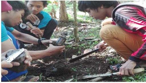
Pengambilan sampel tanah tak terusik pada Sub DAS Bintoro
