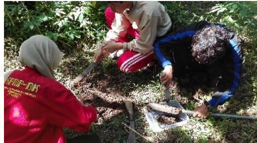
Pengambilan sampel tanah tak terusik pada Sub DAS Kemuning
