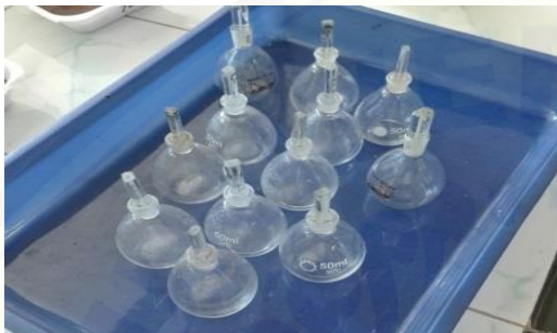
Picnometer yang digunakan untuk uji BJ
