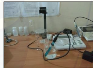
pH meter untuk mengukur pH (keasaman atau alkalinitas)
