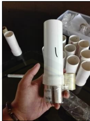
Membalut plastic wrap, untuk mencegah kebocoran
