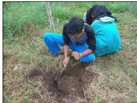
Pengambilan sampel tanah menggunakan ring sampel
