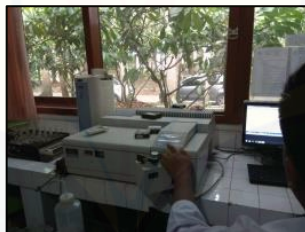
Mengukur absorbansi larutan jernih dengan spektrofotometer dengan panjang gelombang 561 nm
