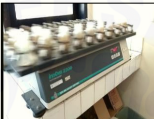
Mesin pengocok sampel, kemudian diamkan 30 menit
