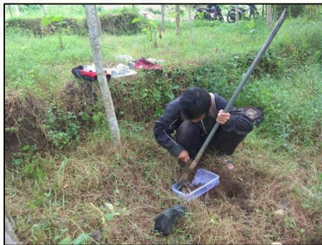
Pengambilan sampel tanah menggunakan bor tanah
