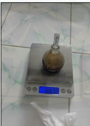
Menimbang picnometer dengan tanah dan air
