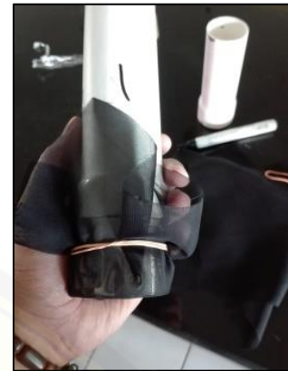
Memasang kain saring, supaya tanah tidak jatuh ke bawah
