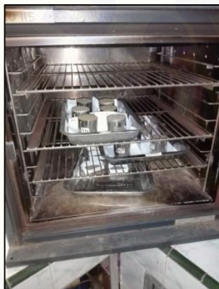
Ring sampel berisi tanah di oven selama 24 jam
