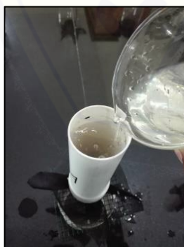
Proses penambahan air setiap waktu, supaya posisi air tetap pada 12 cm dari permukaan tanah
