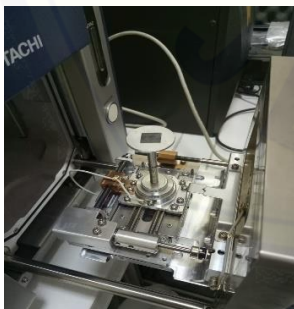
Pemasukan Preparat pada Alat SEM
