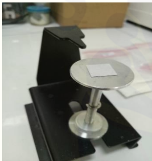
Pemasangan Carbontip Lempeng
