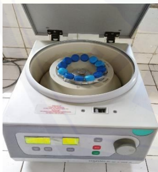
Pemisahan supernatant kecepatan 2500 rpm, 15 menit dengan sentrifuse
