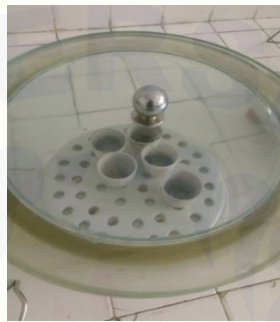
Pengujian kadar air dan kadar abu
