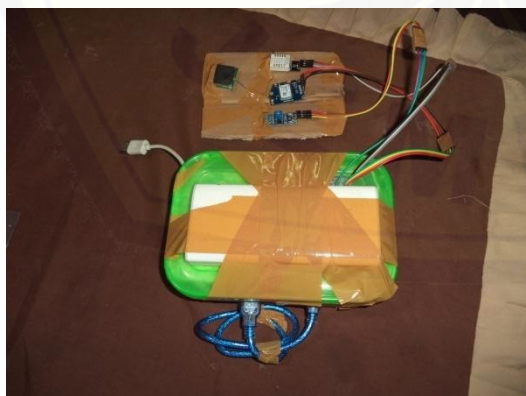
Gambar 5. Rancangan alat perekaman data pada uji lapang
