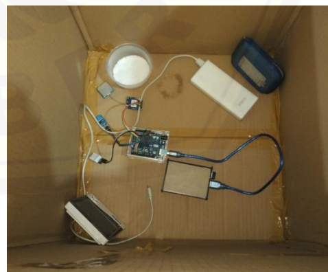
Gambar 6. Rancangan alat pada perekaman data di ruangan garam
