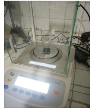
Penimbangan sampel uji kadar air
