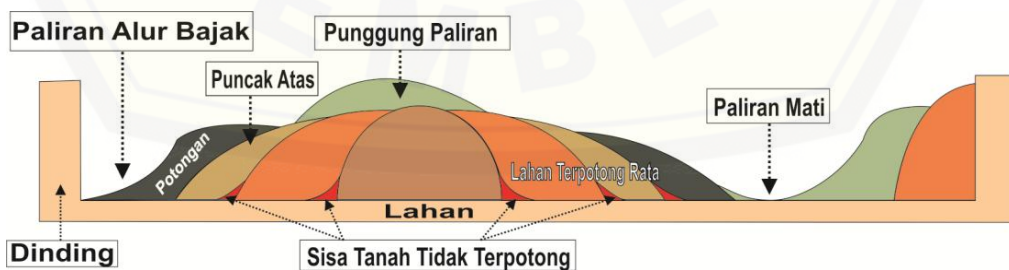
Gambar 2.3 Hasil potongan tanah bajak singkal (Sumber: Smith dan Wilkes, 1990:190)
