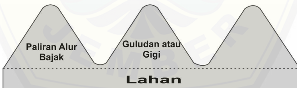
Gambar 2.13 Hasil pola potongan bajak pemalir (Sumber: Smith dan Wilkes, 1990:230)
