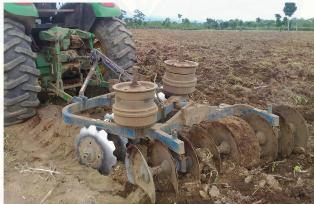
Gambar 2.9 Garu piringan (Sumber: Data Primer, 2016)
