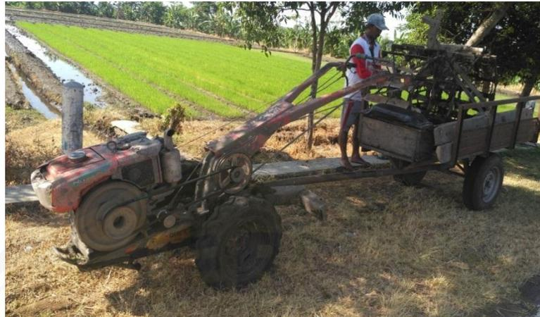
Gambar 1. Traktor Tangan dengan mesin Kubota RD85DI-2S
