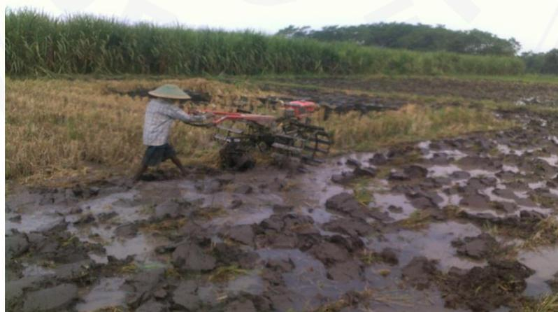
Gambar 3. Pengoperasian traktor tangan
