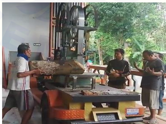
Gambar 2.2 Proses Kerja Kendaraan Pembelah Kayu (Sumber: Dokumentasi Penelitian, 2017)
