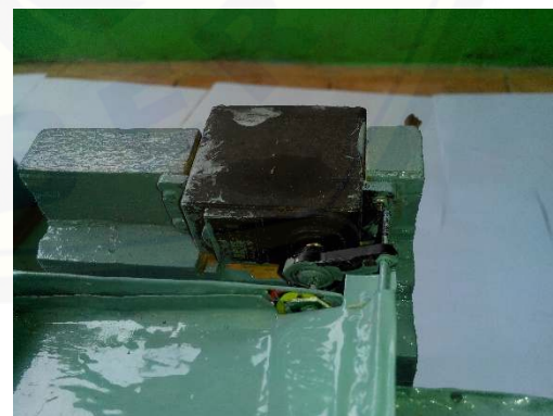
Gambar 18. Peletakan motor servo sebagai penggerak ventilasi
