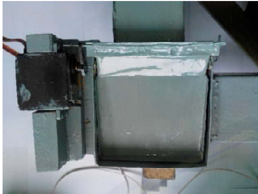
Gambar 19. Rancangan penghubung motor servo dengan ventilasi
