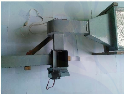
Gambar 3. Penghubung blower dengan ruang pengatur suhu
