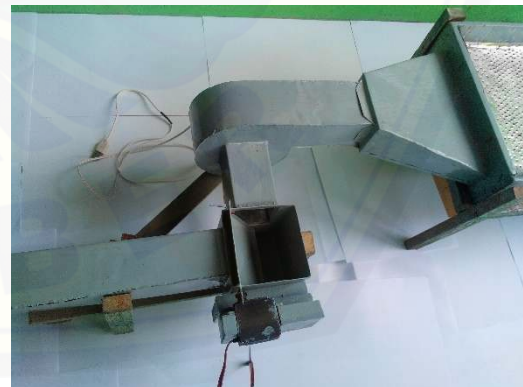
Gambar 24. Penghubung blower dengan ruang pengatur suhu
