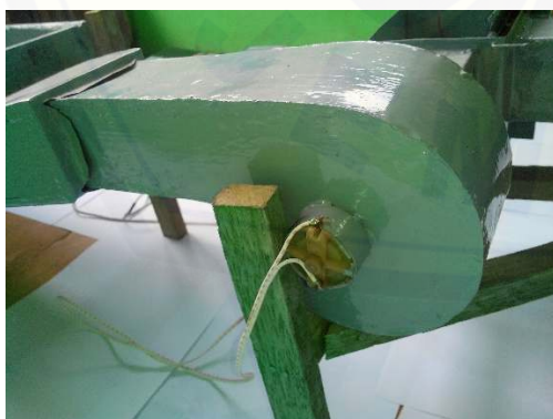
Gambar 17. Peletakan dinamo dc sebagai penggerak blower
