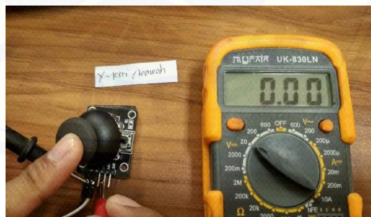
Gambar 21. Modul Joystick Posisi Kiri-Bawah Nilai Arah Y
