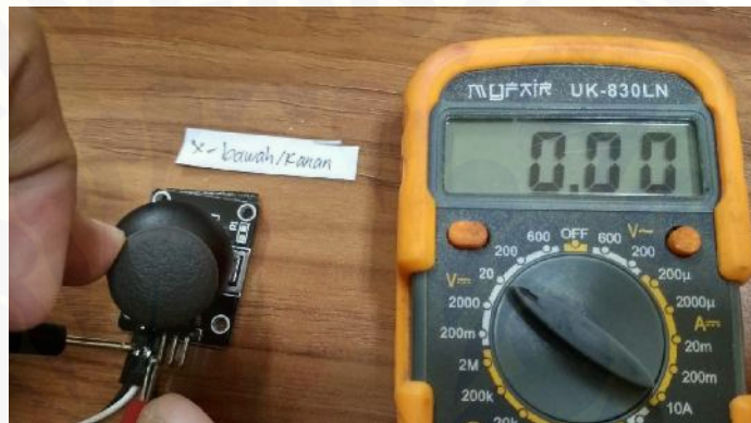
Gambar 14. Modul Joystick Posisi Bawah-Kanan Nilai Arah X
