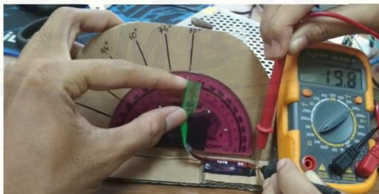
Gambar 3.21 Proses Pengujian Flex Sensor Terhadap Sudut
