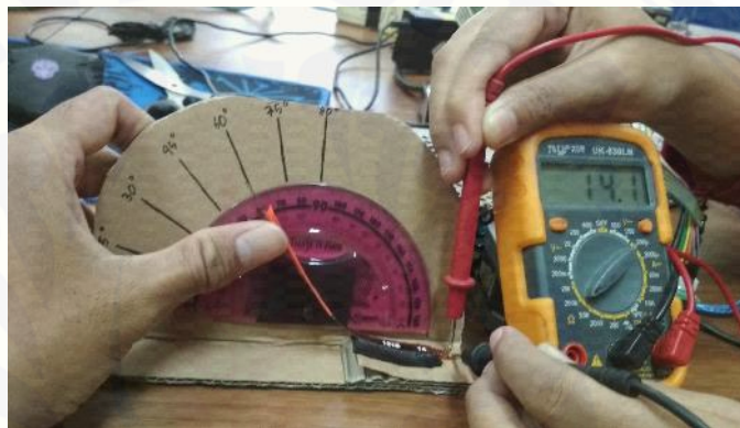
Gambar 5. Flex Sensor Saat Sudut 60^\circ
