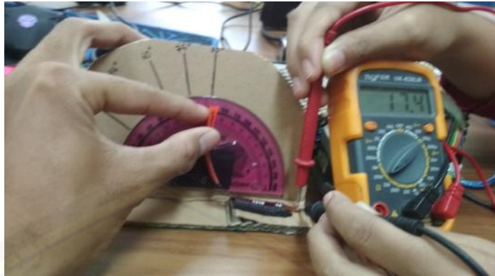
Gambar 7. Flex Sensor Saat Sudut 90^\circ
