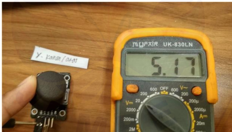
Gambar 3.22 Proses Pengujian joystick dengan Kombinasi Arah
