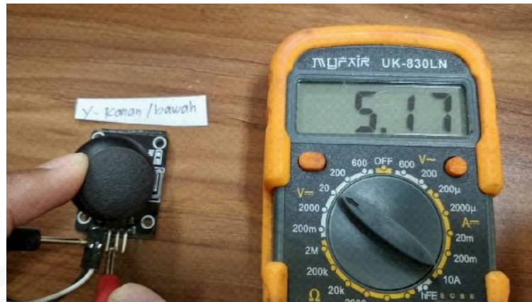
Gambar 19. Modul Joystick Posisi Kanan-Bawah Nilai Arah Y
