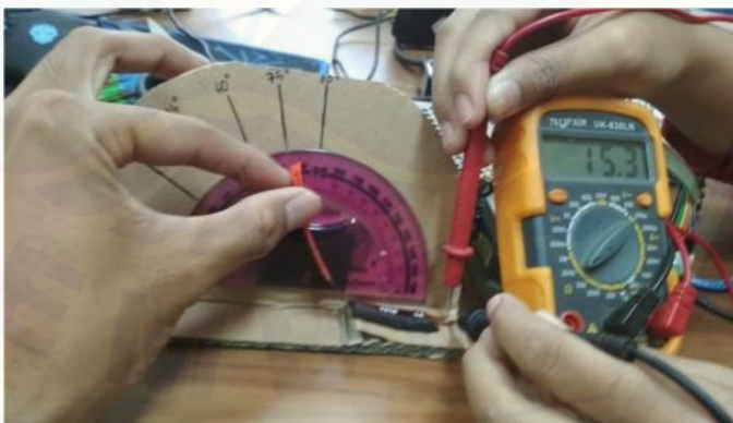
Gambar 6. Flex Sensor Saat Sudut 75^\circ
