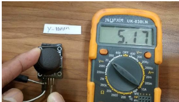
Gambar 16. Modul Joystick Posisi Kanan Nilai Arah Y
