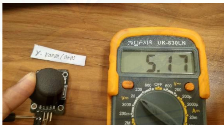
Gambar 18. Modul Joystick Posisi Kanan-Atas Nilai Arah Y
