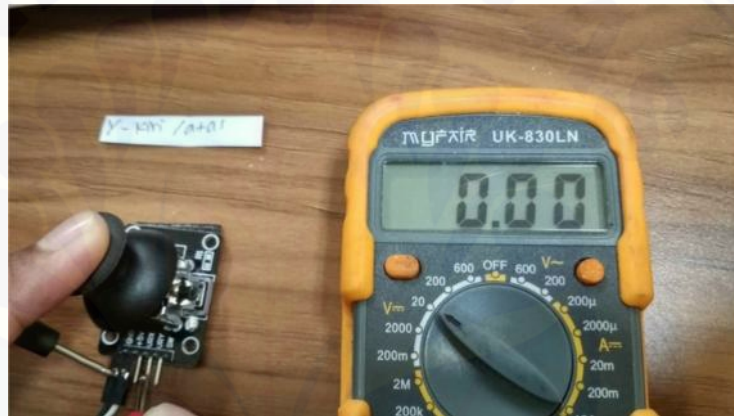
Gambar 20. Modul Joystick Posisi Kiri-Atas Nilai Arah Y
