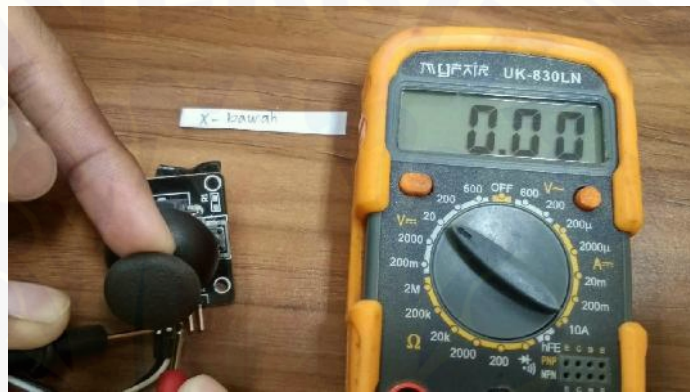
Gambar 11. Modul Joystick Posisi Bawah Nilai Arah X
