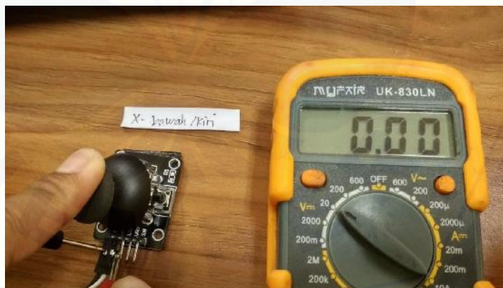
Gambar 15. Modul Joystick Posisi Bawah-Kiri Nilai Arah X
