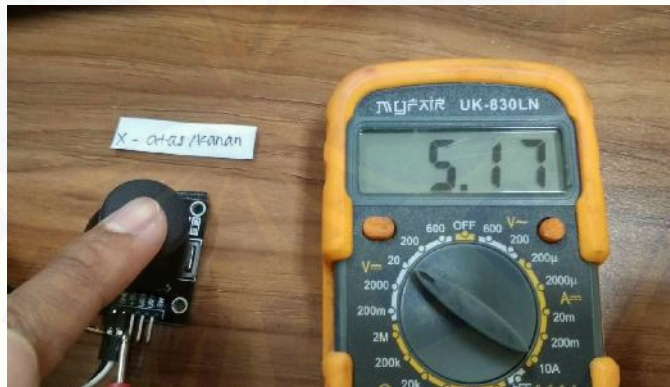
Gambar 12. Modul Joystick Posisi Atas-Kanan Nilai Arah X
