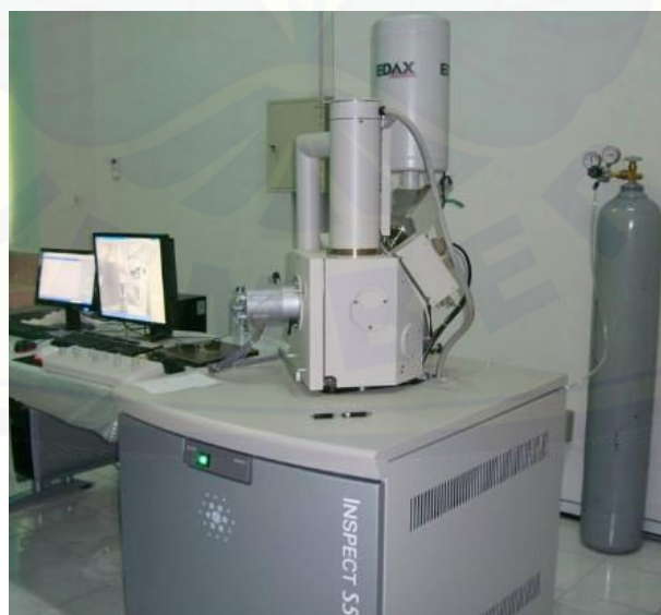
Gambar B.8 Alat Uji Karakterisasi NDT SEM FEI – Inspect S50
