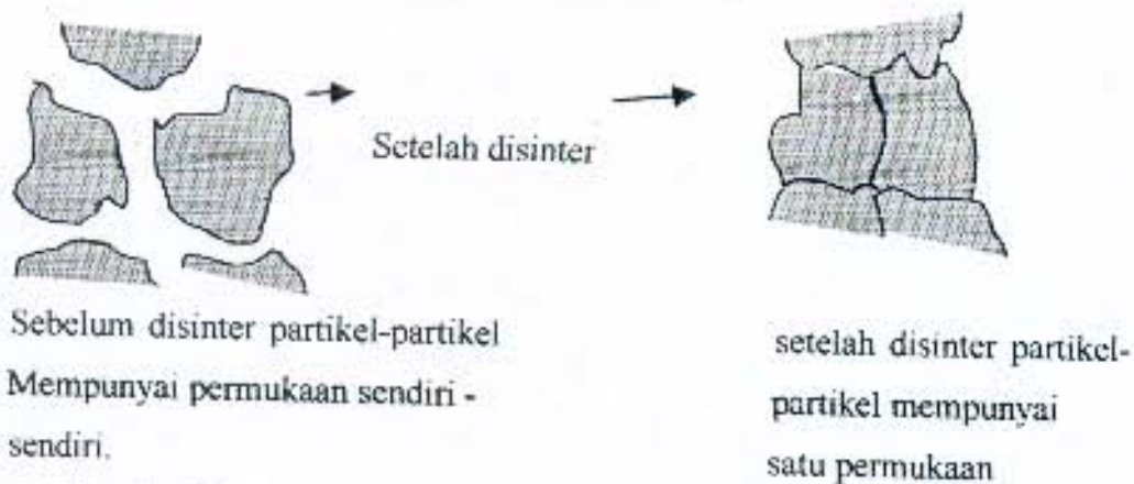
Gambar 2.6 Butiran – butiran bahan sebelum dan sesudah disinter
