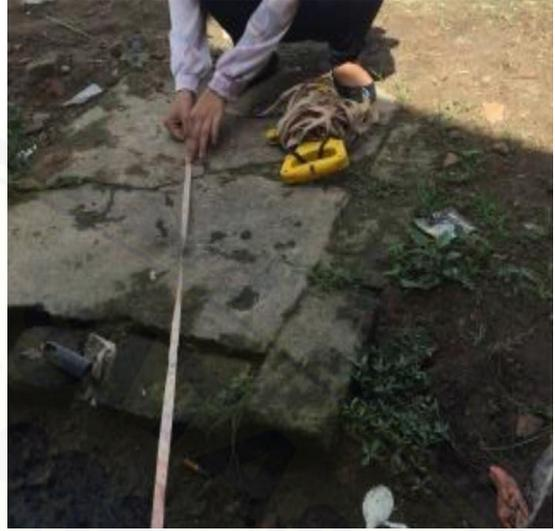
Gambar 10. Jarak Sumur dengan Septik Tank
