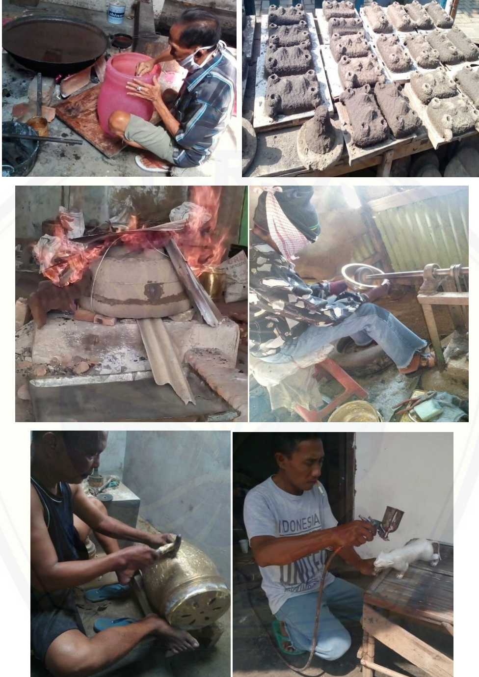
Gambar 5. Proses Pembuatan Produk Kuningan
