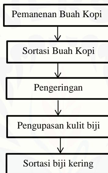
Gambar 2.7 Alur pengolahan kopi secara kering (*Dry Process*)
