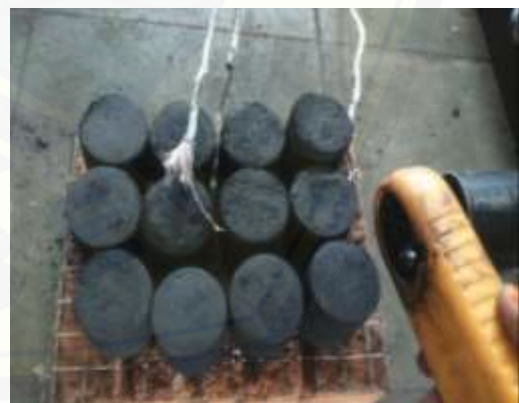
Gambar C 16. Mengatur Aliran Udara Konstan 0,6 m/s
