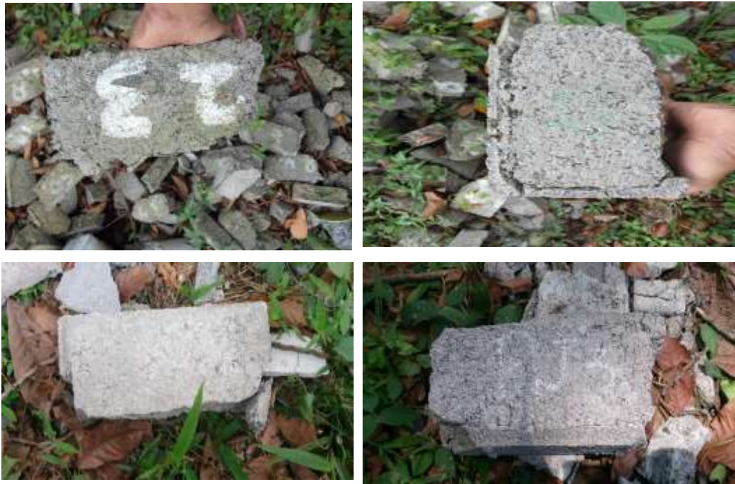
Lampiran 4.29 Bentuk retakan masing-masing benda uji
