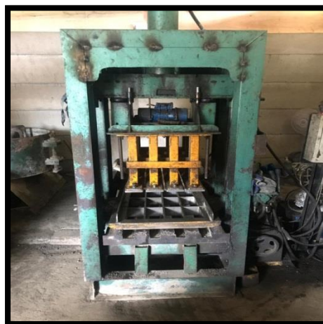
Gambar 3.2 Mesin Press Kombinasi Hidrolis Dan Vibrasi
