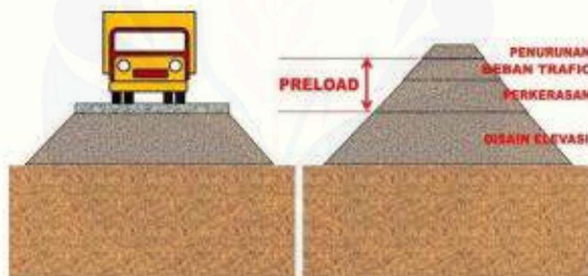
Gambar 2.7 Perencanaan timbunan preload (Sumber: Jurnal Problematika Pembangunan Infrastruktur pada Tanah Lempung Lunak dan Alternatif Metoda Penanganannya, 2015)
