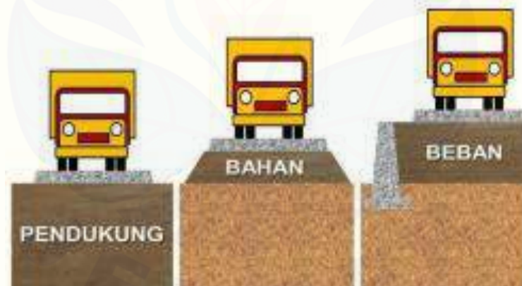
Gambar 2.2 Peran tanah pada konstruksi (Sumber: Jurnal Problematika Pembangunan Infrastruktur pada Tanah Lempung Lunak dan Alternatif Metoda Penanganannya, 2015)
