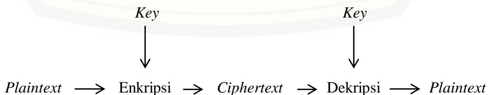
Gambar 2.1 Proses enkripsi dan dekripsi pada Playfair Cipher
