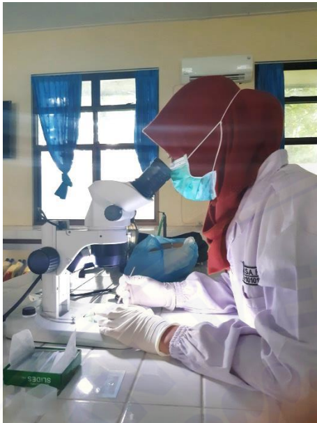
Gambar 4. Pengamatan sampel debu menggunakan mikroskop stereoskopik
