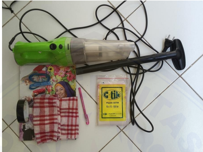
Gambar 1. Alat dan bahan pengambilan sampel debu
