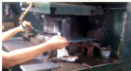
Gambar 2.4 Proses stamping (Sumber : Dokumentasi Pribadi)
