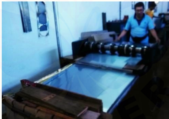
Gambar 2.2 Proses slittering (Sumber : Dokumentasi Pribadi)
