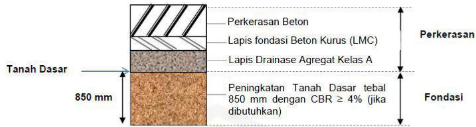
Gambar 2.6 Perkerasan Kaku pada Galian
