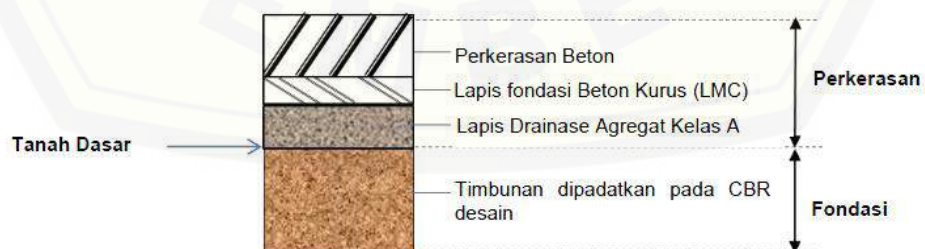
Gambar 2.5 Perkerasan Kaku pada Timbunan
