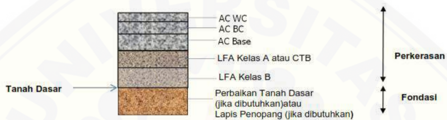
Gambar 2.3 Perkerasan Lentur pada Galian
