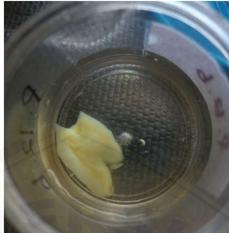
Gambar 3.3 Proses dekalsifikasi sampel dengan asam nitrat 10%
