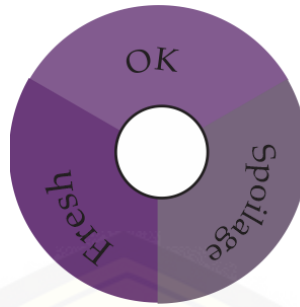
Gambar 3.1 Desain label pintar sebagai sensor kesegaran
