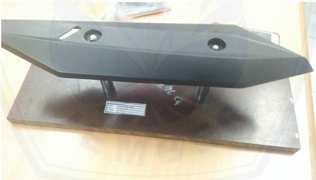
Gambar F.6 Pengukuran Menggunakan Standar Perusahaan (JIG)
